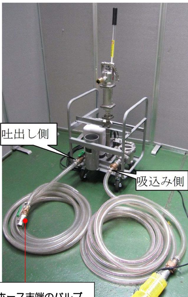
ホース末端のバルブを開け、自動運転ユニット付属のコンセントを電源に差し込んでください。
