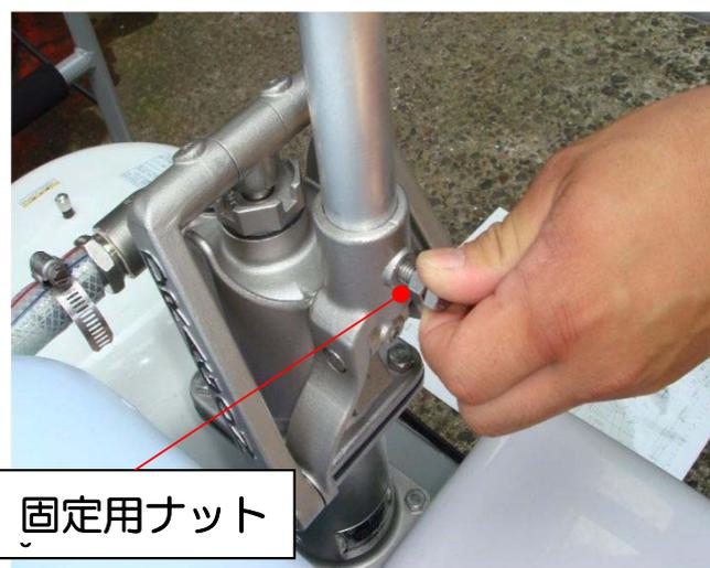
ハンドルの穴位置に合わせてボルトを回し、ナットにて固定してください。
