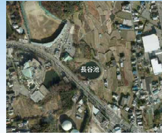
● 堤長: 136m ● 堤高: 6.9m ● 貯水量: 7,700m 3
