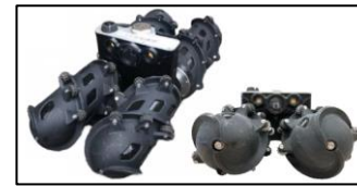
管内ドローンカメラ （自走式）
