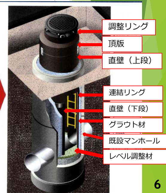
補強後の人孔
