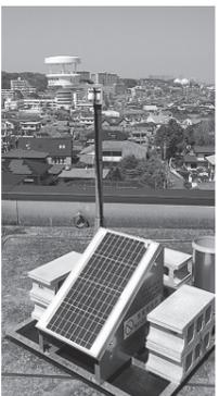
POTEKA®は雨量、温度、湿度、気圧、風向、風速、日射を測定することができる小型気象観測システムで、近年頻発している局地的な集中豪雨による浸水害や土砂災害に対応するため、ポイントの気象情報をリアルタイムで観測することができ、防災対策のほか、夏の豪雨被害や熱中症、外出前の雨雲の確認などに活用されています。
