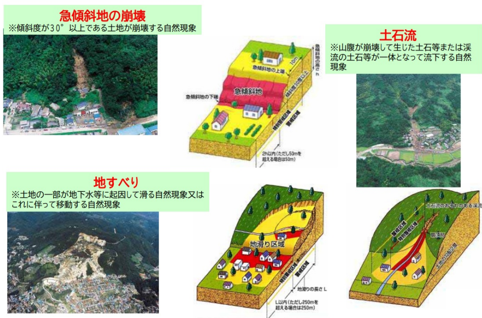
図 3-6 土砂災害の種類と土砂災害警戒区域及び土砂災害特別警戒区域の概要（国土交通省）
