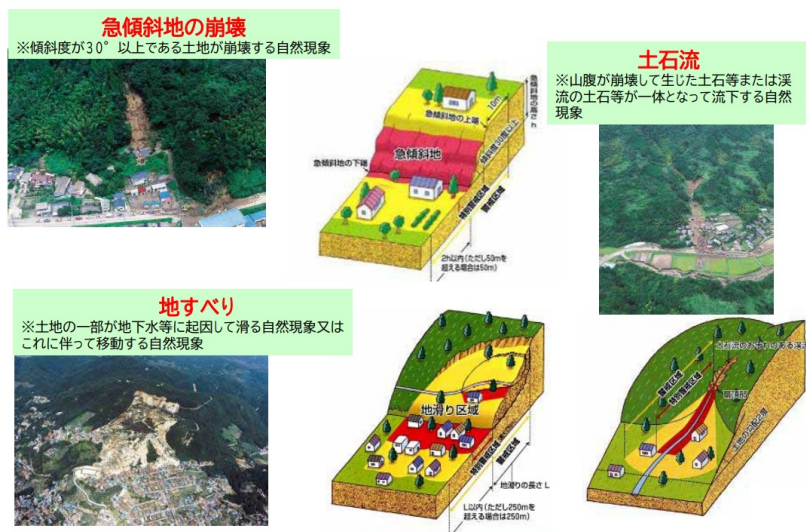
図 3-7 土砂災害の種類と土砂災害警戒区域及び土砂災害特別警戒区域の概要（国土交通省）
